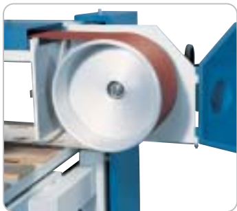
Große Bandlaufrollen ( Durchmesser 270 mm ) sorgen für optimalen und vibrationsfreien Lauf.
