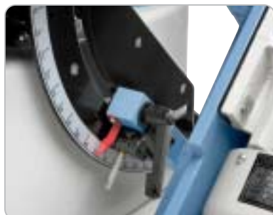
Schwenkbares Schleifaggregat (90° - 0°) mit Arretierung bei 0°, 45° und 90°
