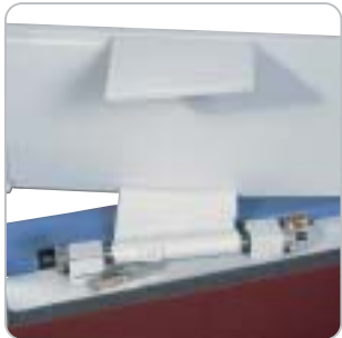
Schleifanschlag mit Feineinstellung und Selbstarretierung
