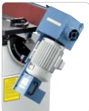
Robuste Schwenkeinrichtung. Schrägstellung des Schleifaggregates von 0° - 90° möglich
