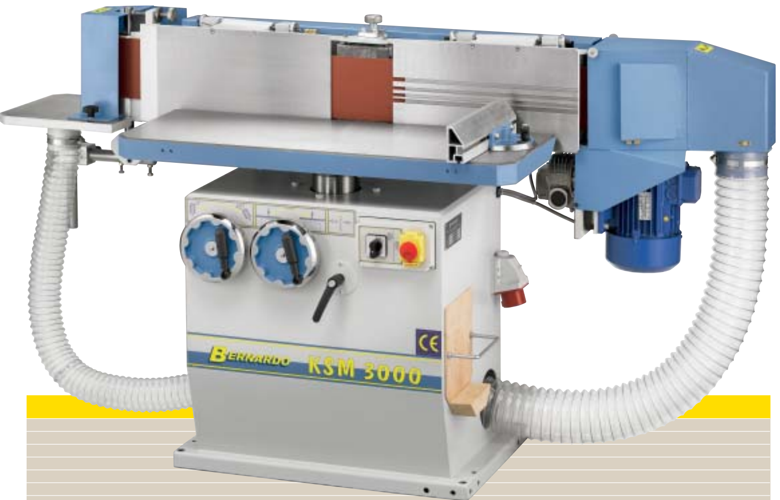
Höhenverstellbarer Radienschleif- tisch mit Absaugung und Schleifwalze mit Gummibelag zum Schleifen von Radien
