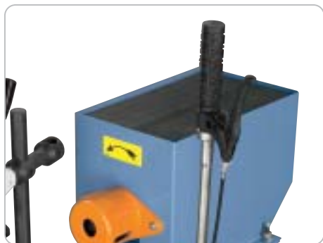
Motorabdeckung als Werkzeugablage verwendbar
