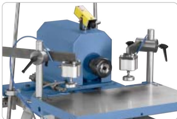
Die pneumatischen Spannzyllinder ergänzen die umfangreiche Grundausstattung
