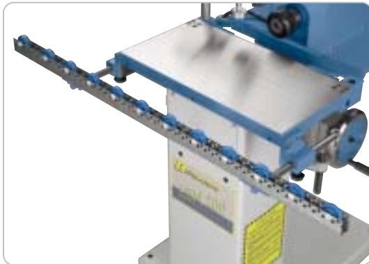
Ausziehbare Tischverbreiterung für große Werkstücke
