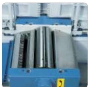
Beste Hobelergebnisse durch die großzügig dimensionierte 4-Messerhobelwelle mit voreingestellten Wendehobelmesser
