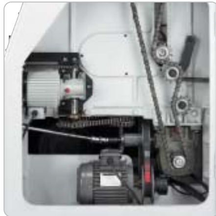
Mit dem Variatorgetriebe kann die Vorschubgeschwindigkeit der Ein- und Auszugswalze für präzise Hobelergebnisse optimal an das Werkstück angepasst werden
