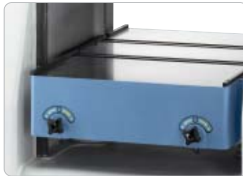
Massiver Dickentisch aus Grauguss, motorisch einstellbar von 4 - 300 mm Arbeitshöhe. Die Höhenverstellung erfolgt über 2 großdimensionierte Spindeln, die Führung mit vier Präzisionsflachführungen ist für höchste Beanspruchung ausgelegt
