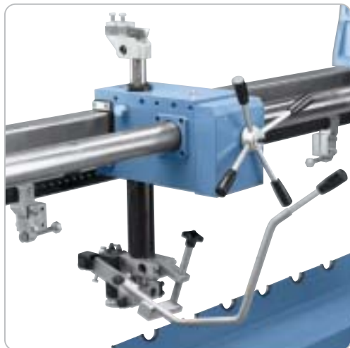
Stabiler Spindelstock für vibrationsfreies und sauberes Arbeiten. Abbildung mit 4-Backenfutter diam. 125 mm (Option).
