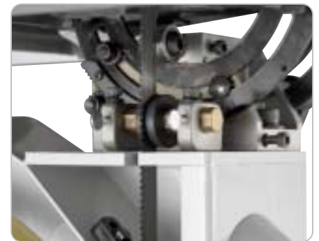
Die wartungsfreie Präzisionsrollenführung ober- und unterhalb des Säge tisches sorgt für eine optimale Führung des Sägebandes
