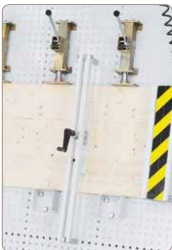
Niederhalter mit Spindelklemmung für großflächige Werkstücke
