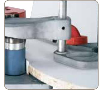
Höhenverstellbare Führungsplatte für Plattendicken von 10 – 40 mm
